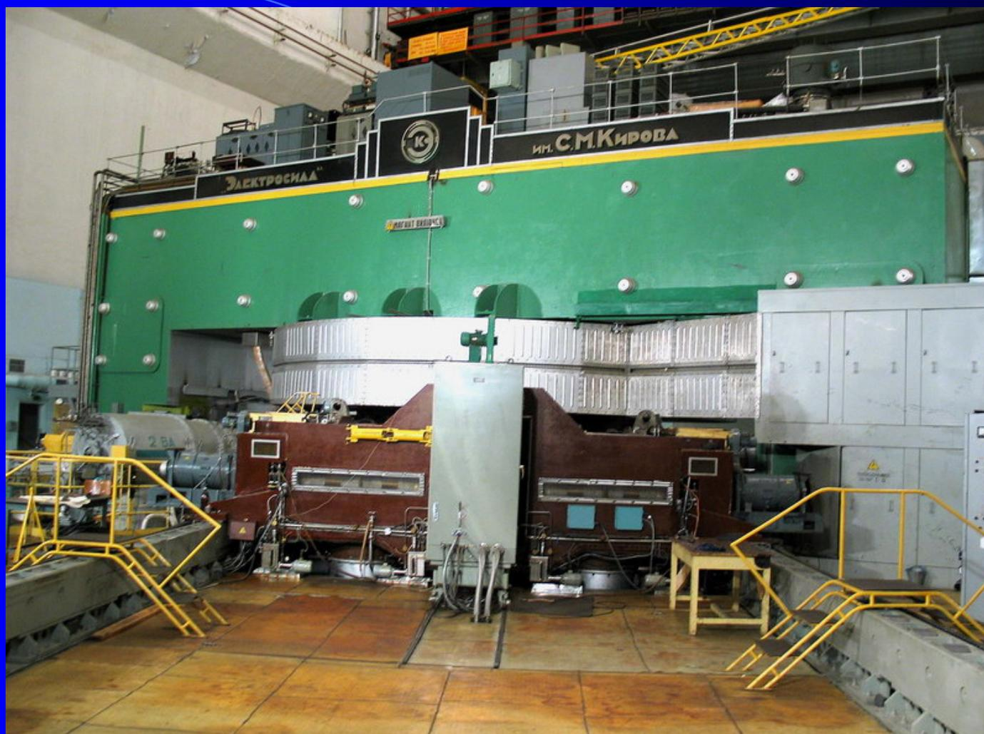
Протонный ускоритель (фазотрон) на энергию 660 МэВ
