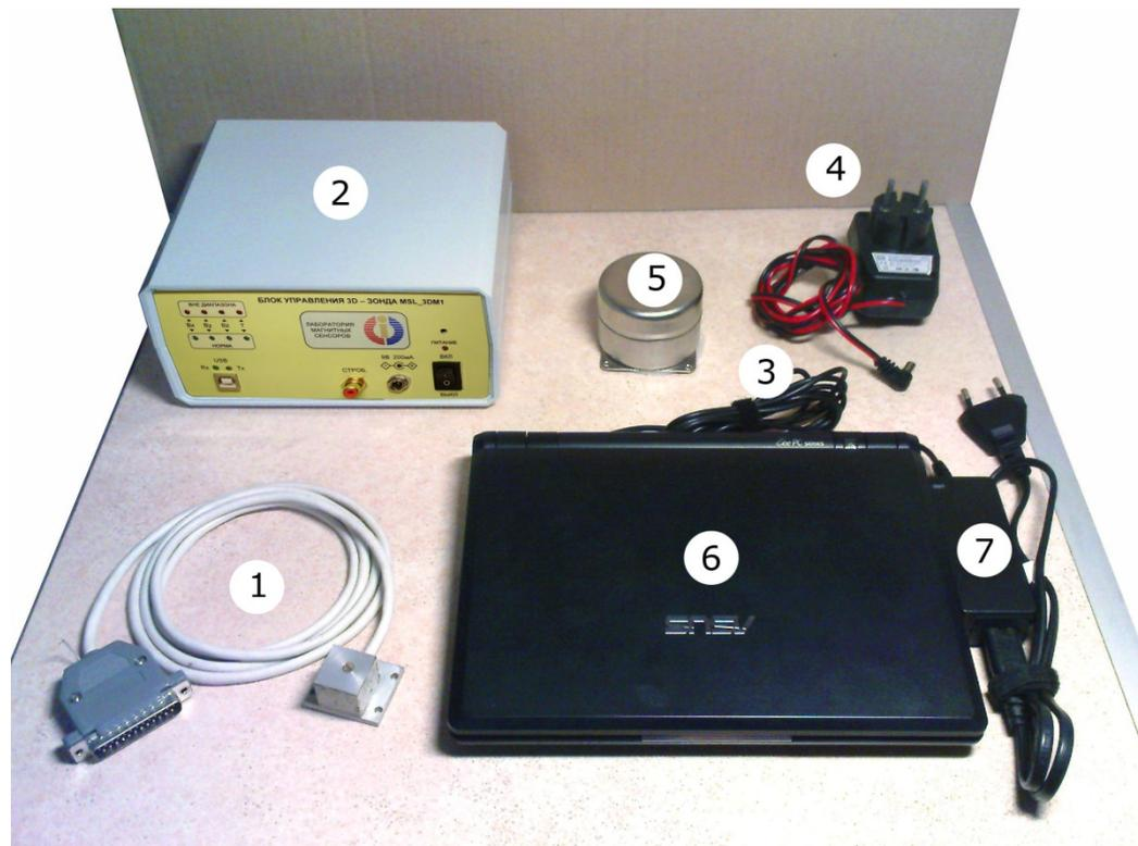
Состав: 1 – трёхкоординатный 3D зонд с холловскими сенсорами для измерения пространственного распределения компонентов вектора магнитной индукции в сверхпроводящих соленоидах; 2 – блок управляющей электроники; 3 – кабель USB; 4 – блок питания к блоку управляющей электроники; 5 – нуль-камера для экранирования 3D зонда от магнитного поля Земли; 6 – ноутбук для визуализации результатов измерения; 7 – блок питания для ноутбука.
